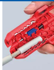
Odizolování kabelu NYM
