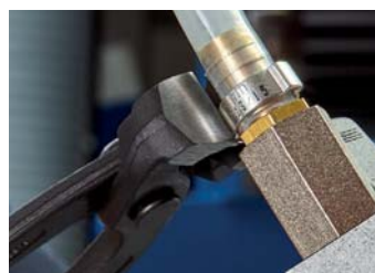
10 98 I220: Utěsnění připojení hadice na centrálním mazání
