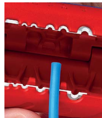
90 22 02 SB: Praktická pomůcka pro polohování usnadňuje vkládání jednotlivých vodičů pro odizolování
